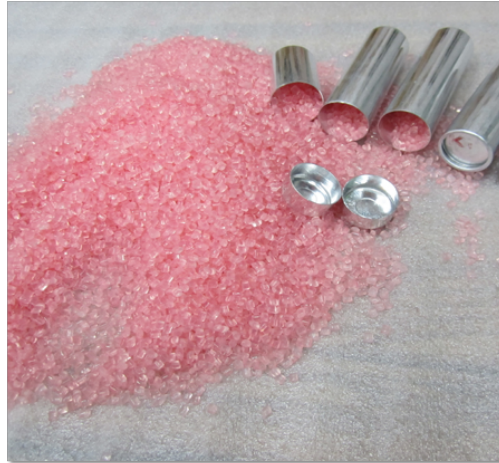
Figure 2 : Pastilles de résine flexible chargées dans des cartouches Figure 2: Flexible resin pellets loaded into cartridges
